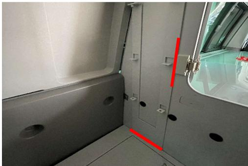
4. Position der Halterung rechts: Halterung auf dem Boden aufstehen lassen und rechts bis an das Scharnier der Tür schieben, Halterung an vorgesehener Position fest andrücken
