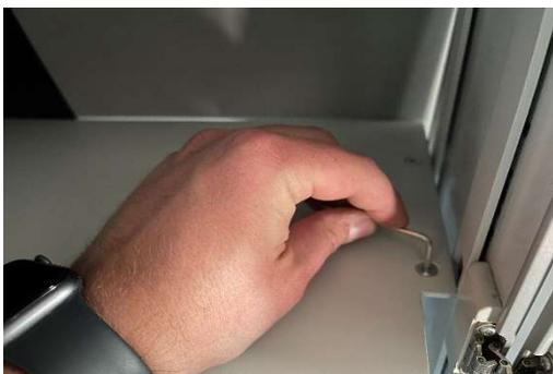
10. Wenn alle Böden montiert sind, alle Schrauben fest anziehen
