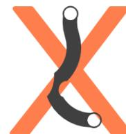
Verwenden Sie das CaliHeat nur bei gedrehtem Beifahrer Sitz um ein knicken des Abluft Schlauchs zu vermeiden!
