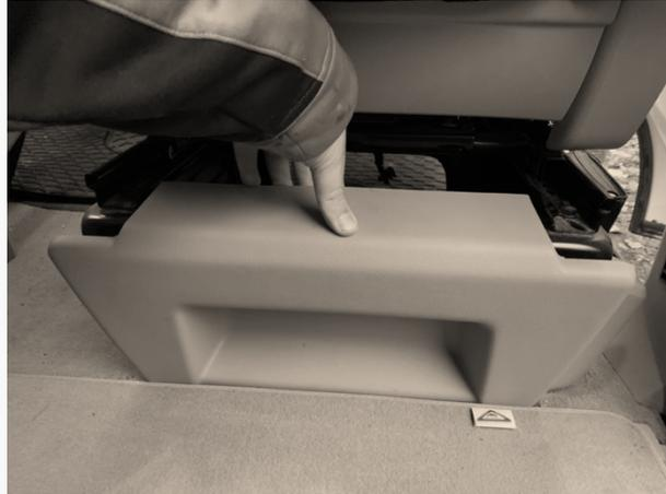
3. Bohrung an der entsprechenden Stelle anzeichnen (siehe Foto). Wenn vorhanden, Körner benutzen. Mindestens ein 7mm Loch bohren.
